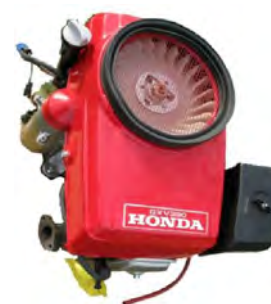
Art. HONDA GXV 390 MOTOR ZA KOSA ICU HONDA GXV 390 SNAGA 10.2 hp / 389 cc MAX. BROJ OBRTAJA 3000 RADILICA 25.4 X 80
