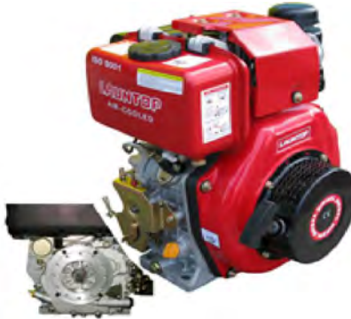
Art.LA 186 DIZEL LAUNTOP HORIZONTALNI MAX. SNAGA 10 ks KUBIKAŽA 418 cc MAX. BROJ OBRTAJA 3600 ULJNI FILTER REZERVOAR GORIVA 5.5 l RADILICA KONUS fi 18 - 22mm TEŽINA 48 kg
