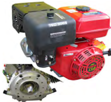
Art. LT 340 LAUNTOP MAX. SNAGA 11 ks KUBIKAŽA 337 cc MAX. BROJ OBRTAJA 3600 VAZDUŠNI FILTER REZERVOAR GORIVA 6.5 l RADILICA KONUS 18 - 22mm TEŽINA 31 kg
