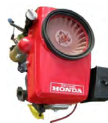
Art. HONDA GXV 390 MOTOR ZA KOSA ICU HONDA GXV 390 SNAGA 10.2 hp / 389 cc MAX. BROJ OBRTAJA 3000 RADILICA 25.4 X 80
