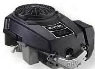
Art. KOHLER SV 480 MOTOR ZA KOSA ICU KOHLER SV 480 SNAGA 18 hp / 635 cc MAX. BROJ OBRTAJA 3000 RADILICA 25.4 X 80
